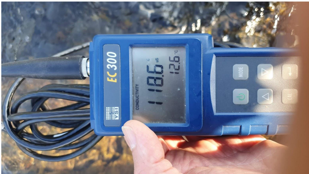
Mynd 5. YSI EC300 notaður til mælinga á seltu, leiðni og hitastigi
